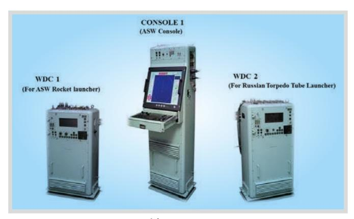
IAC MOD 'C' FIRE CONTROL SYSTEM FOR TORPEDO & ROCKETS
